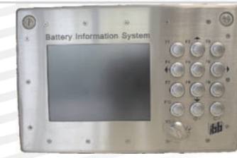
Batteriemanagementsystem für U-Boot-Antriebsbatterien
